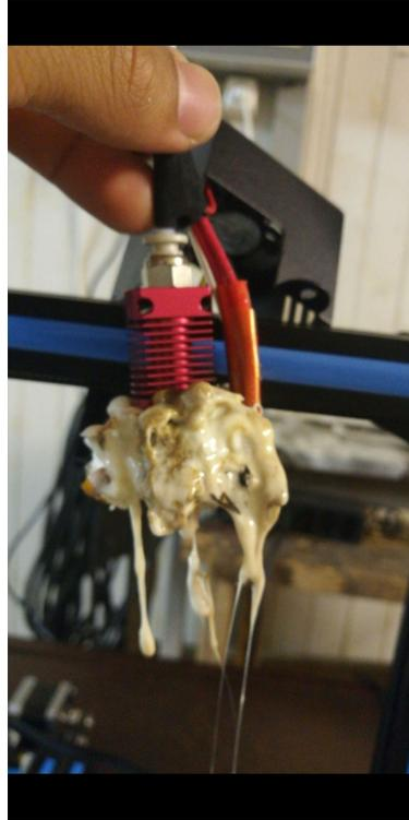
*Abbildung 6: Filamentstau im Druckkopfgehäuse 2*
