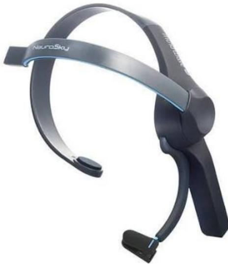
*Abbildung 9: Elektroenzephalografie Messgerät "MindWave Mobile" der Firma "NeuroSky"*
