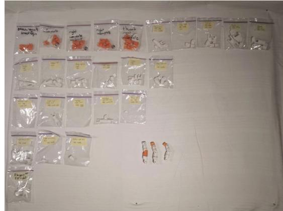
Abbildung 24: 5 Generationen Finger, die erste in der obersten Reihe, die fünfte zu unterst. Die, welche unten fehlen, sind entweder zerbrochen oder eingebaut worden. Rechts unten liegen noch drei der ersten "fertigen" Generation, welche ästhetisch ebenfalls nicht überzeugten
